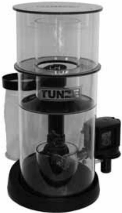
Gleichmäßige Leistung: die Zwischenkammer mit Phasenwasser und patentiertes Anti Overfoaming System vermeidet ein Überkochen des Abschäumers und reguliert die Schaumleistung. Wasserenergie des Ausgangswassers nutzen: alle DOC Skimmer enthalten einen abnehmbaren Postfilter, der eine perfekte mechanische Filterung auf 300µm Acrylwattefäden durchführt. Der Postfilter kann mit Filtermedien wie Aktivkohle oder Phosphat-Adsorber gefüllt werden.
