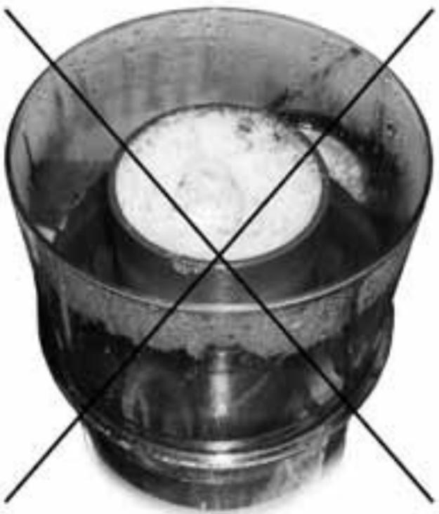
**Störung: Der Abschäumer produziert Schaum, aber dieser Schaum steigt nicht ins Reaktorrohr.**
